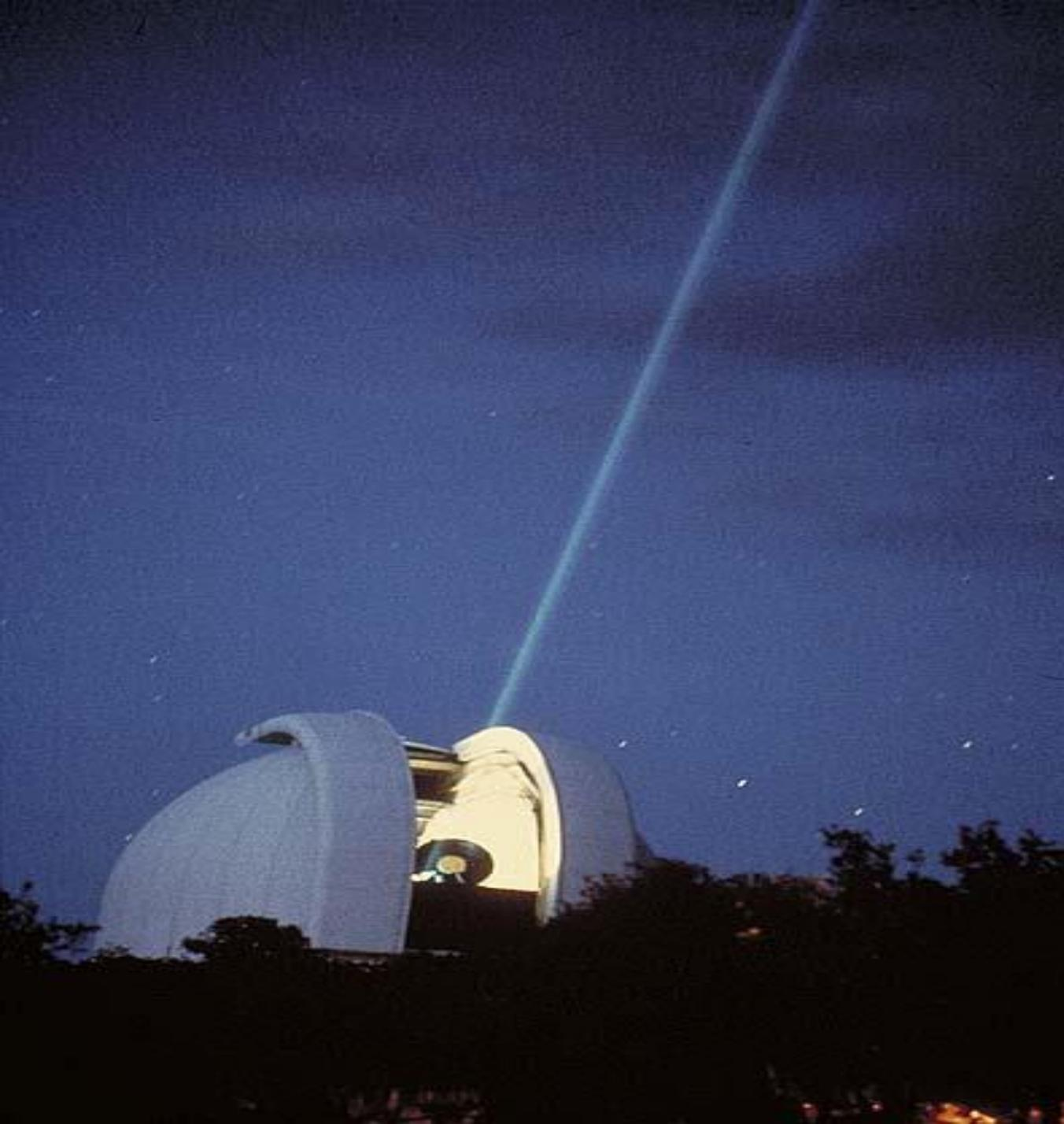
Das 2,7-Meter-Harlan-J.-Smith-Teleskop des McDonald-Observatoriums (USA) wird benutzt, um mit einem Laser die auf dem Mond stationierten Spiegel anzuvisieren.
